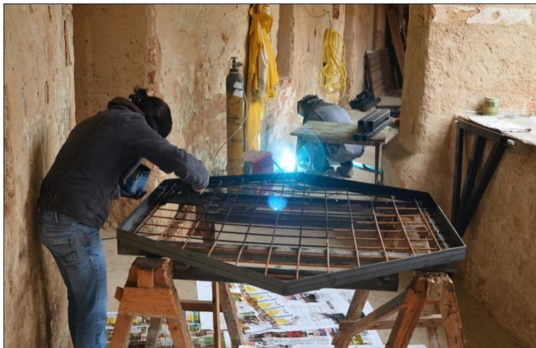
Slika 7: Izdelava novega gnezdilnega podstavka za belo štorcljo
